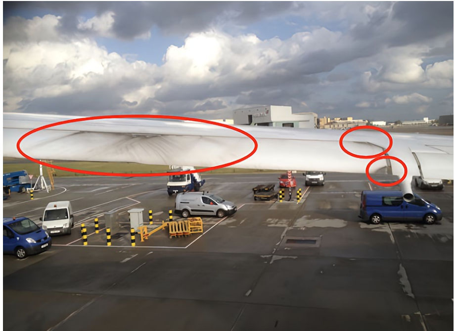
Punaiset ympäröidyt alueet ovat Unitedin 787 salamien kiinnityspisteet oikeassa siivessä. Kuva: NTSB.
