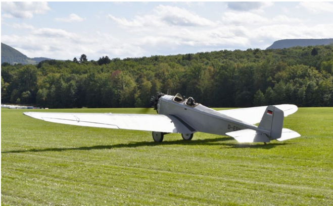
Suomen ilmavoimienkin kalustoon kuuluneen 1920-luvun Klemm L-25 VI:n siipien kärkiväli on peräti 13 metriä.
